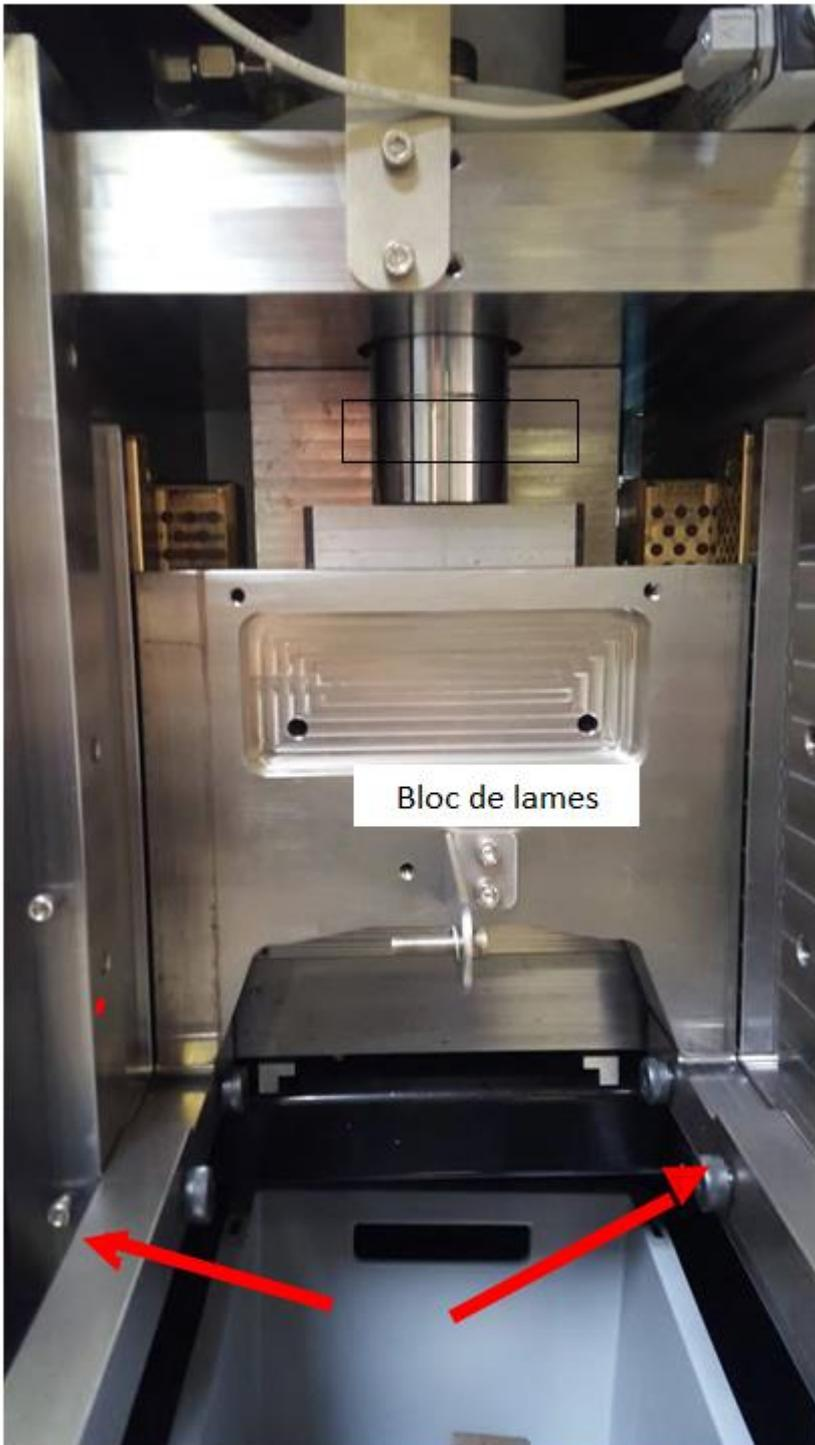
Déposez avec précautions le bloc de lames en l'enlevant du cylindre en poussant vers vous. Placez le bloc de lames à plat sur les barres en fer (flèches rouges ci-dessus).
