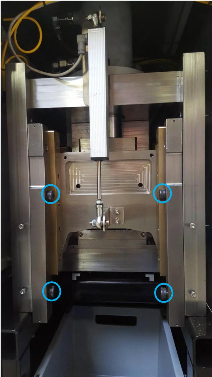
Desserrez les boulons (ci-dessus dans les cercles bleus) afin de déposer les barres de fer.
