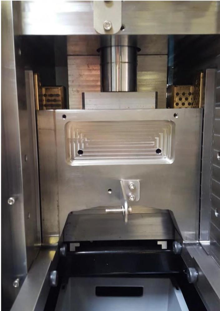
Après avoir remplacé les lames, placez le bloc de lames en haut à droite et déplacez-le doucement vers l'arrière. Afin de le positionner correctement autour de la tête de piston, vous devez soulever un peu le bloc
