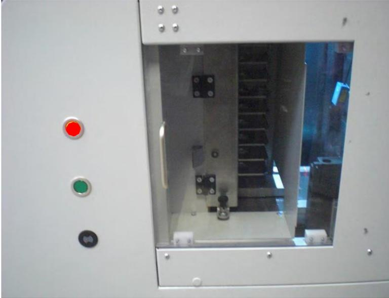
Ci-dessous la façon correcte de positionner le disque dur dans le bac de chargement.
