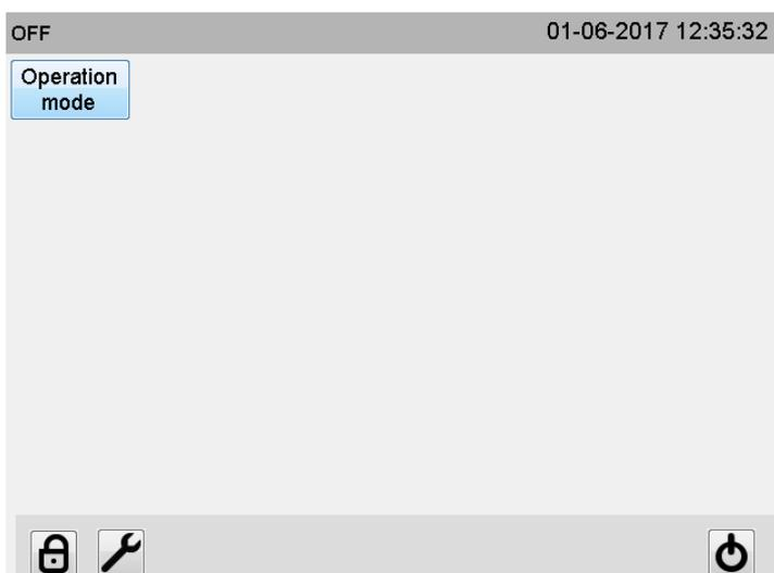
Cliquez sur "Mode Opérationnel" pour indiquer à la machine de retourner à sa position de départ.
