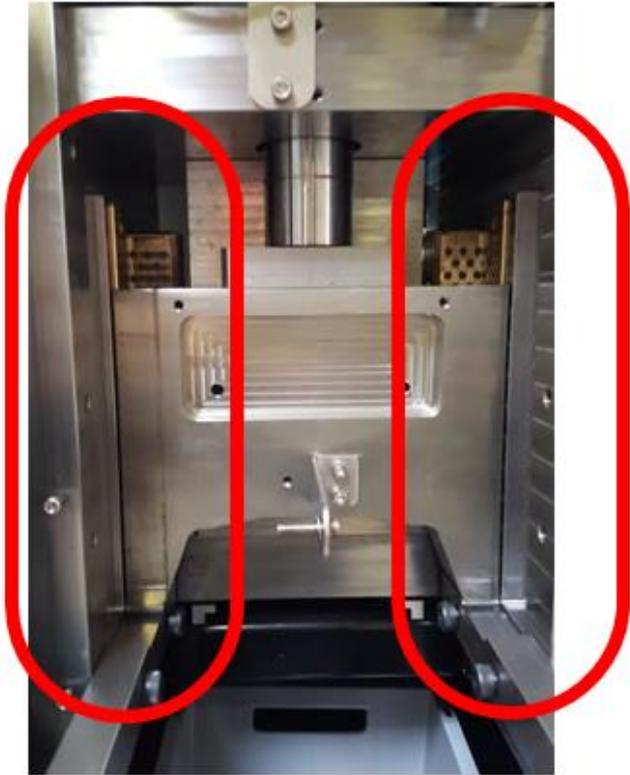
**Avant d'installer à nouveau les garde-corps en laiton, nettoyez méticuleusement les cavités situées sur les deux côtés.**
