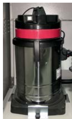
Aspiration avec filtre HEPA
