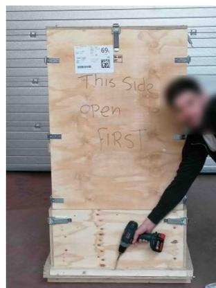
**2/** Ouvrir les loquets du couvercle supérieur afin de le retirer et le déposer sur le côté.
